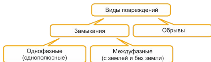
Рис. 1 Виды повреждений кабельных линий
