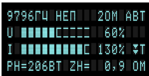
Рисунок 6.4 – Режим ограничения по температуре (▼T)
