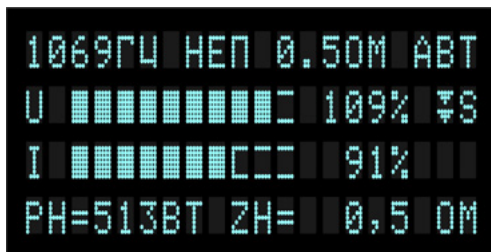
Рисунок 6.2 – режим ограничения по мощности (▼S)
